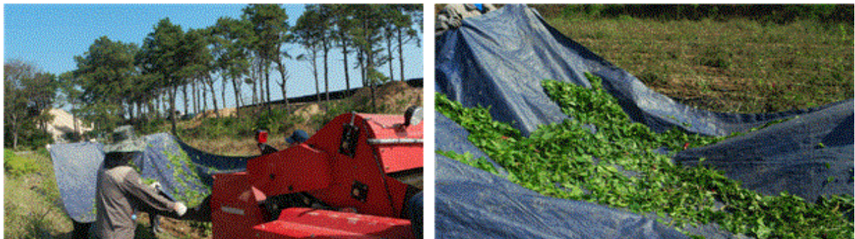
그림 124. 송풍에 의하여 선별된 줄기 및 잎 수집 시험 모습
