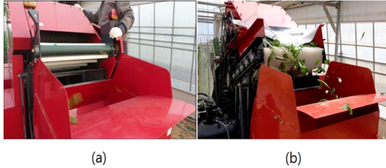
그림 219. 카드클리너 장착 유-무에 따른 고추 수확기 선별부
