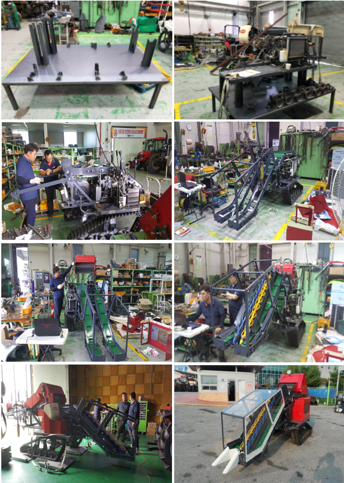
그림 42. 중형 고추수확기 시작품 조립 및 제작
