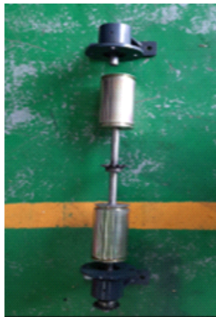
<탈실부 구동 축 파손>
