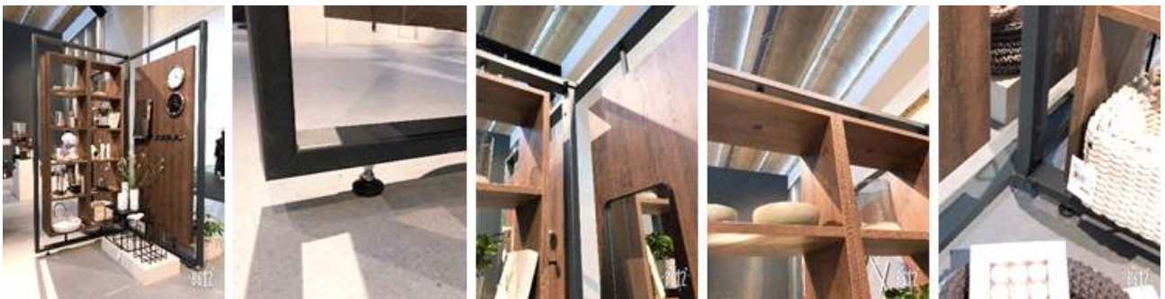
그림 110. 선적, 면적 부재가 하드웨어로 간단히 결합되어 벽 구조물이 되는 사례 1
