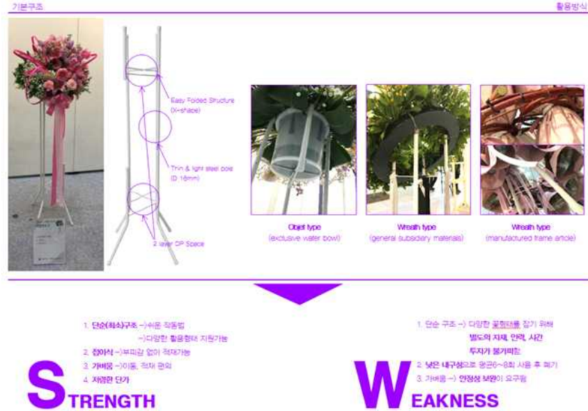
그림 90. X자형 신화환대 관절 구조 및 연출 방식
