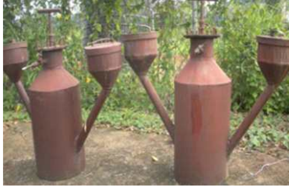
<그림 73> 나이지리아 대학의 실험에 사용된 바이오 소화기(Bio digester, 프로토타입)
