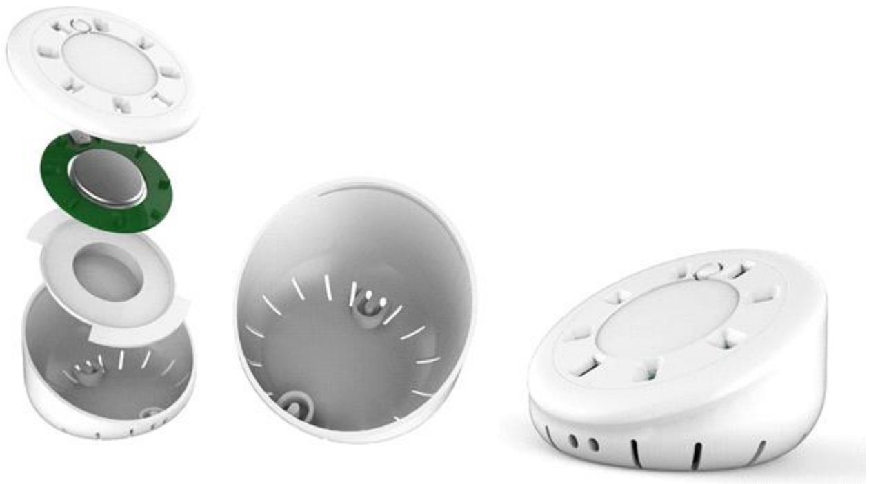
그림 4-63. 신선도 유지물질 충전부와 조합 파장 가능하게 보완 설계된 2차년도 시제품
