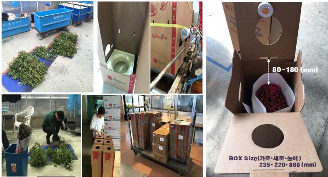
그림 4-5. 수출용 장미의 MEFI 패키지 모듈 장착 과정
