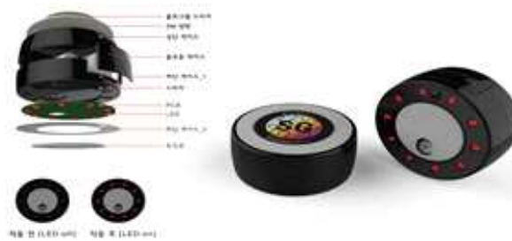
그림 4-61. MEFI모듈의 기능 집적후 소형화 과정
