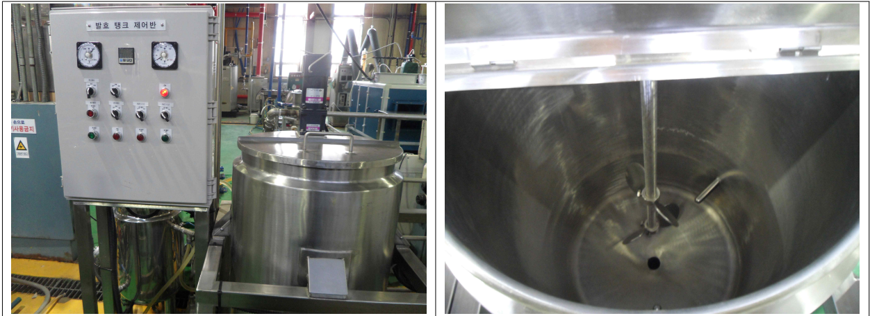
(그림 10) 발효조 외관과 내부 임펠러의 모습
