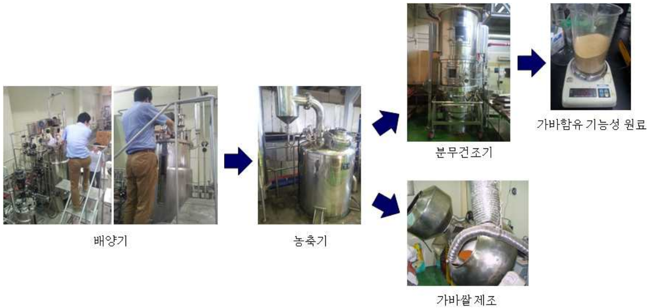
Fig. 10. Lactobacillus brevis RB-28의 500L pilot scale 배양 시스템
