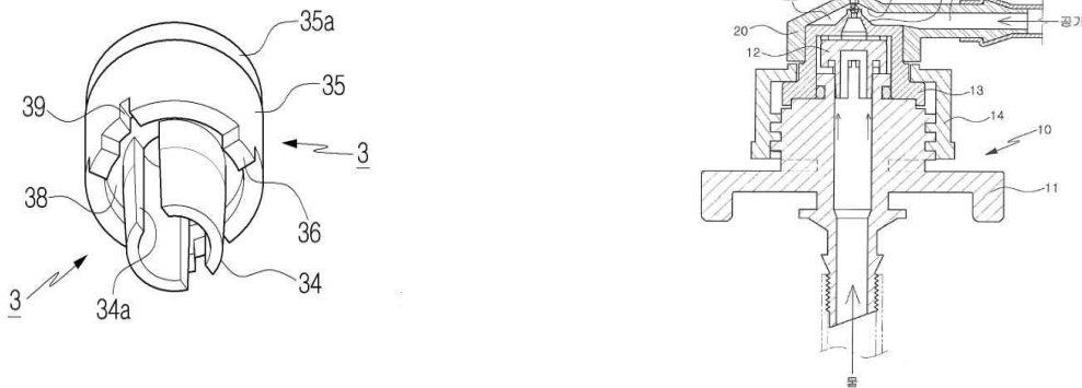
그림. 21 포그시스템에 적용한 노즐의 막힘방지 구조
