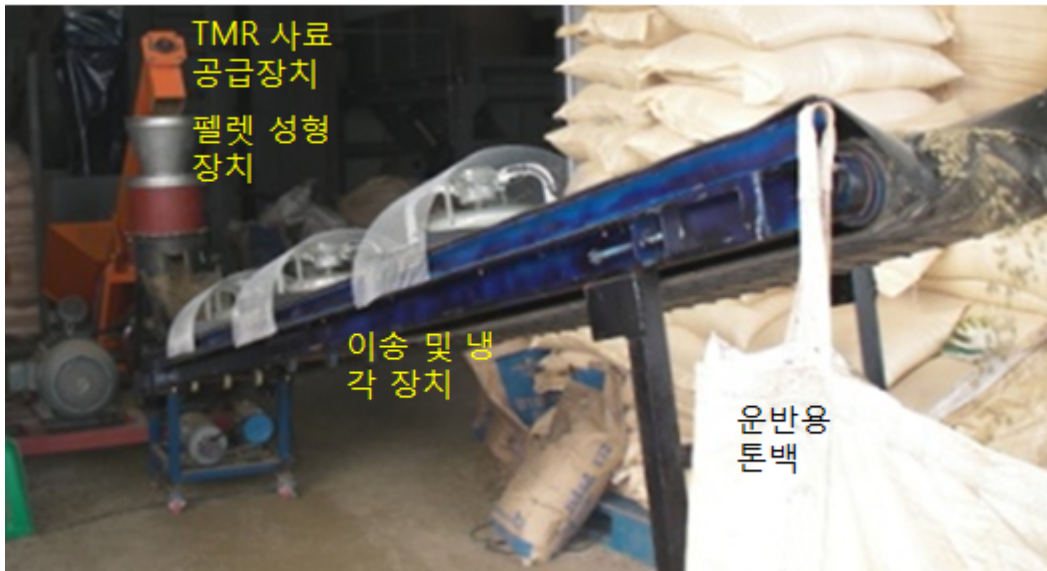
<그림 14> 현장설치된 TMR 펠릿제조 시스템
