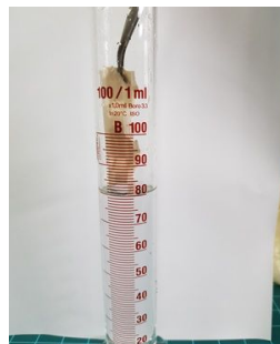
그림 52. 밀도를 계산하기 위해 실행한 실험 방법(좌: 무게측정, 우: 부피측정)
