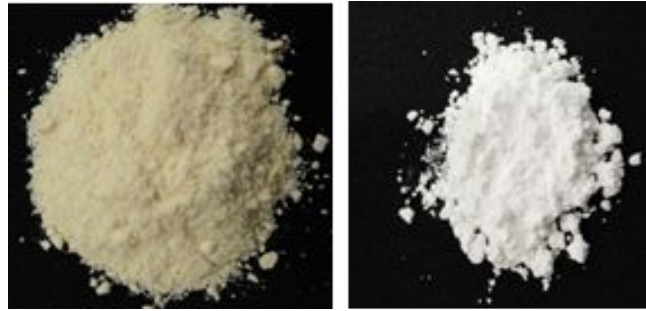
그림 16 EDA 함량 증가로 인한 황변현상 상변화 입자(좌)와 개선 된(우) 상변화 입자
