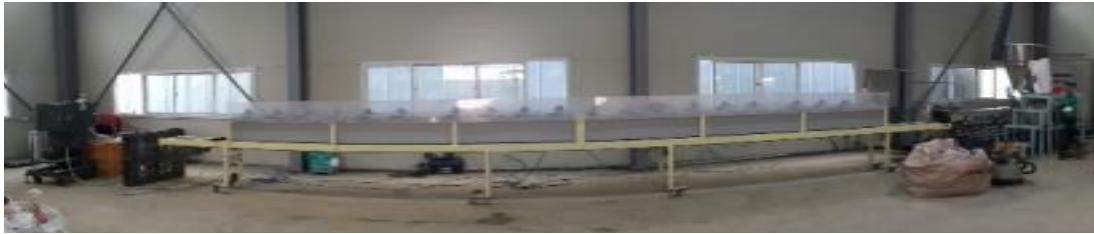
그림 11 바이오매스 플라스틱 M/B 제조를 위한 공랭식 압출기
