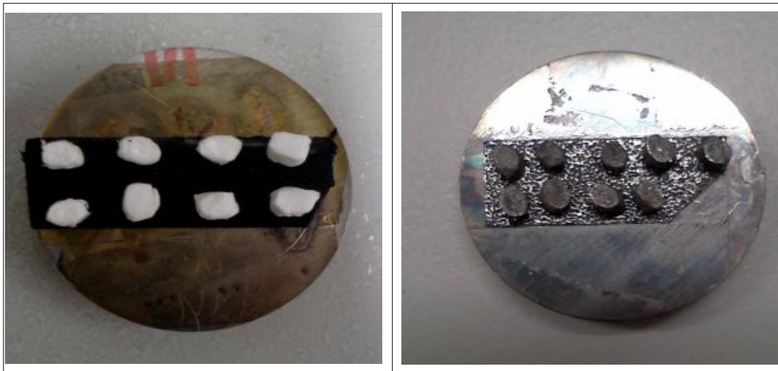
그림 14. 전자현미경(SEM)을 이용한 빙결정 생성을 관찰하기 위한 시료 준비(좌: 백금코팅 전, 우: 백금코팅 후)
