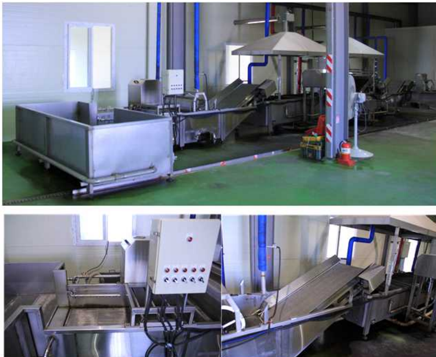
그림 2. 자동화 모시 데침 시설. 열탕, 운반벨트, 냉수세척기, 탈수기로 구성되어 있음.
