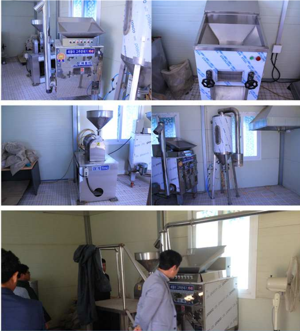
그림 3. 모시분말 제분설비. 우측상단부터 고추분쇄기, 롤러밀, 기류식분쇄기, 모시분말 챔버의 도관 연속구조로 되어 있음.
