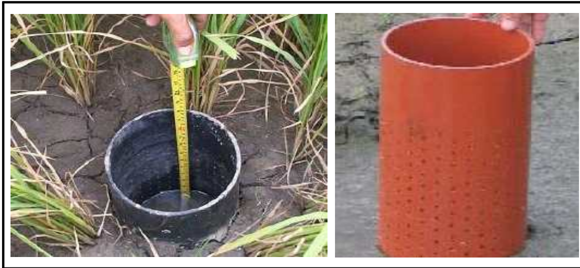
<그림 3-3-11> 효율적인 관개를 위한 물관리 제어 장치
