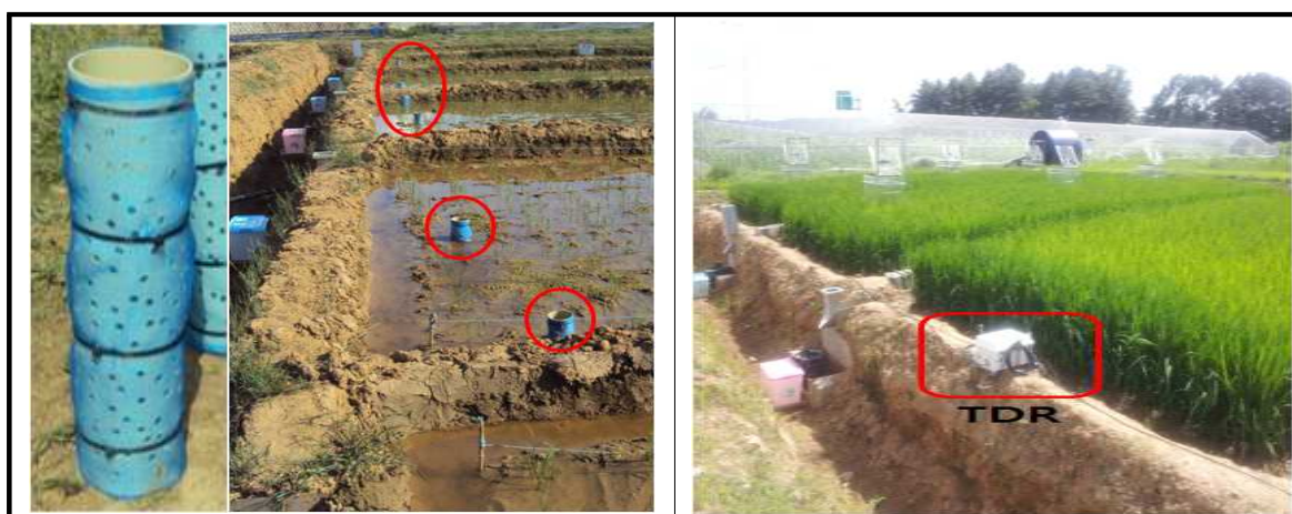
그림 9. 효율적인 관개를 위한 물관리 제어 장치
