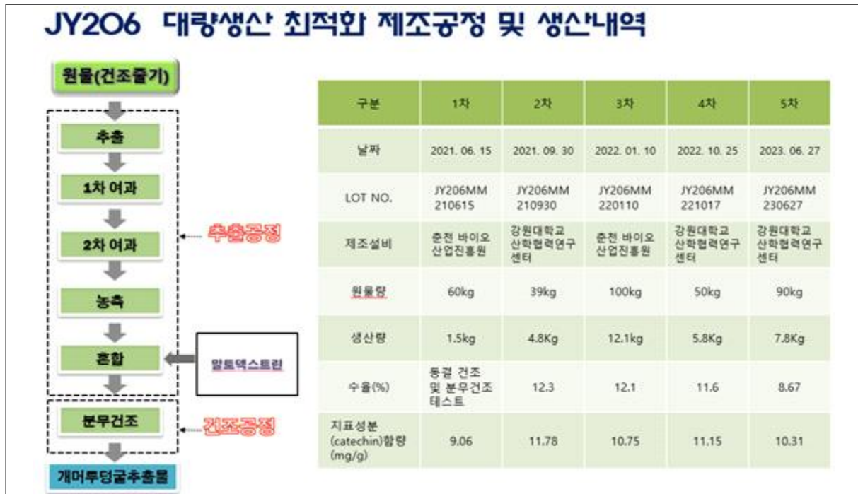
[그림-18] 대량생산 공정 최적화 제조공정도 및 생산내역
