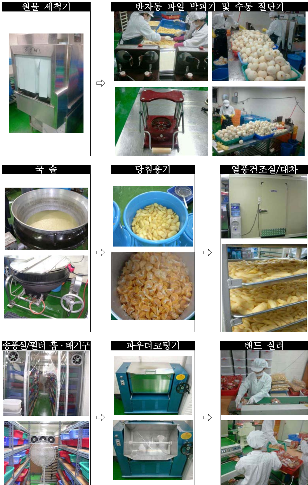
그림 3-12. 공정별 주요 기계 장비
