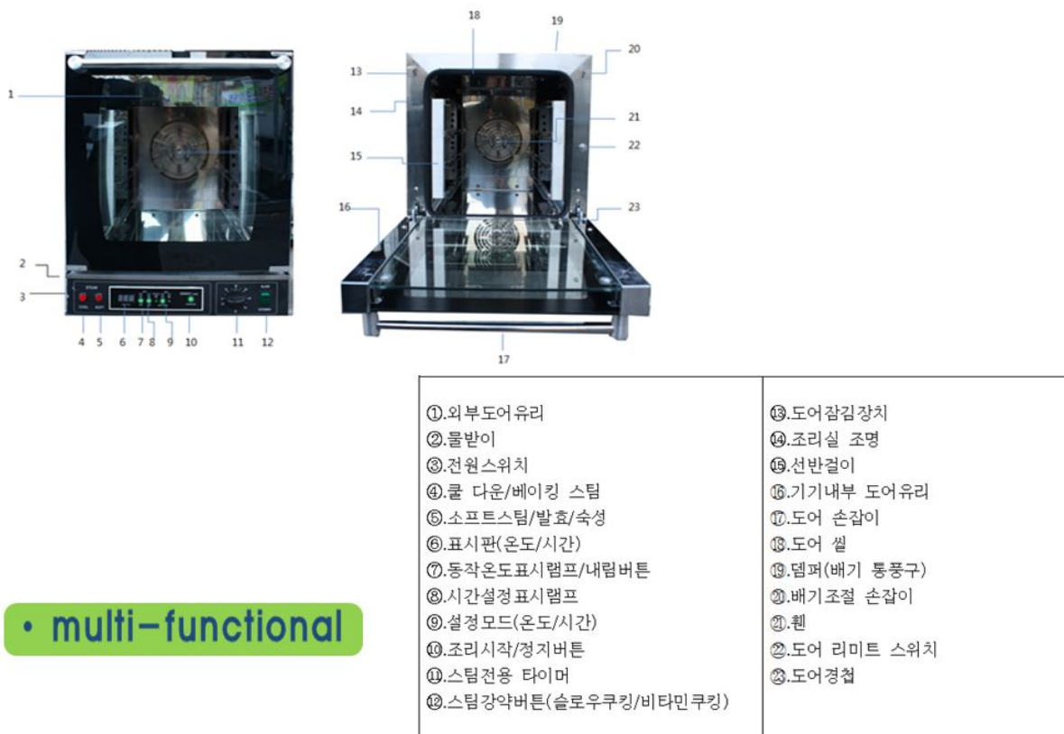
[그림 3-60] 최종 개발된 SHRO의 구조
