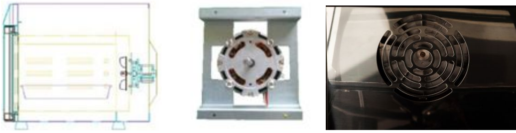
[그림 3-56] AC모터 장착구조 설계 및 보호커버
