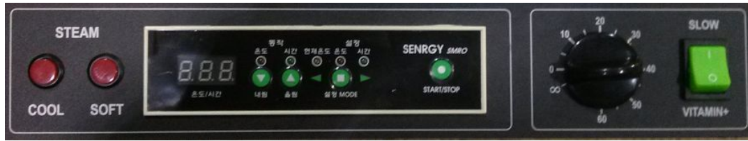
[그림 3-54] 차별기능: 2종류의 스팀과 순수 찜기 전용 컨트롤 및 PCB컨트롤 조립 상태
