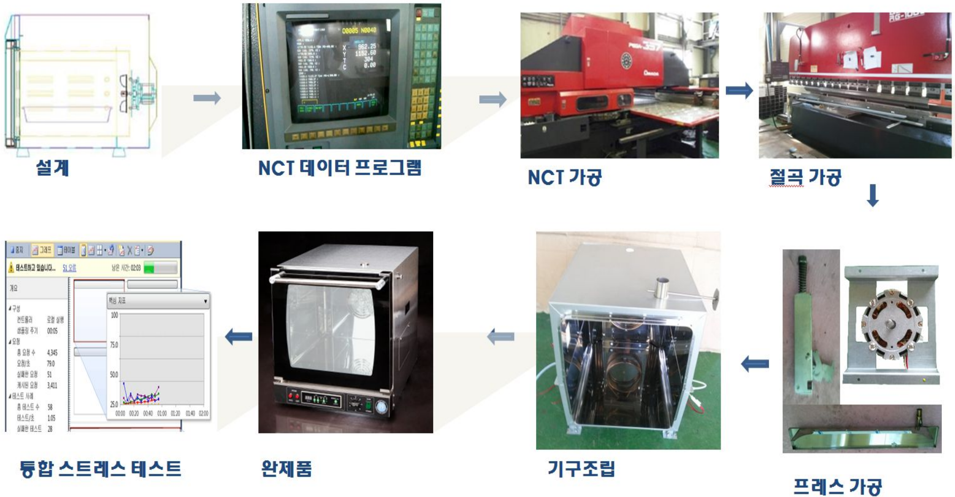
[그림 3-61] SHRO 부품 조리기자재 제조 공정
