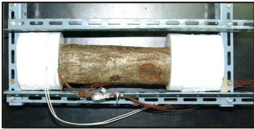
Photo. 6-2, T/C 와 봉 히터, 단열재 설치 시편
