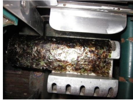
그림 3-16. 김 낱장 공급장치 흡입부에 김이 갇싸인 모습
