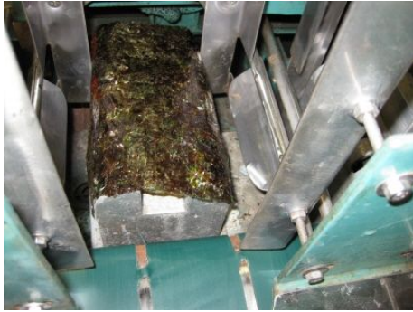
그림 3-16. 김 낱장 공급장치 흡입부에 김이 갇싸인 모습
