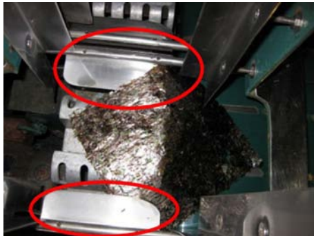
그림 3-17. 이송 컨베이어에 흡입 도중 부품에 끼이거나 걸린 모습
