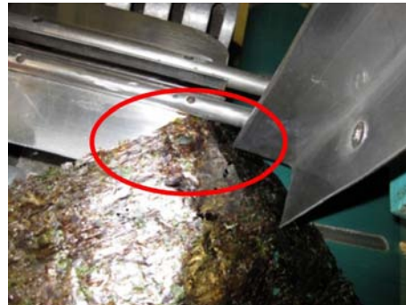
그림 3-17. 이송 컨베이어에 흡입 도중 부품에 끼이거나 걸린 모습
