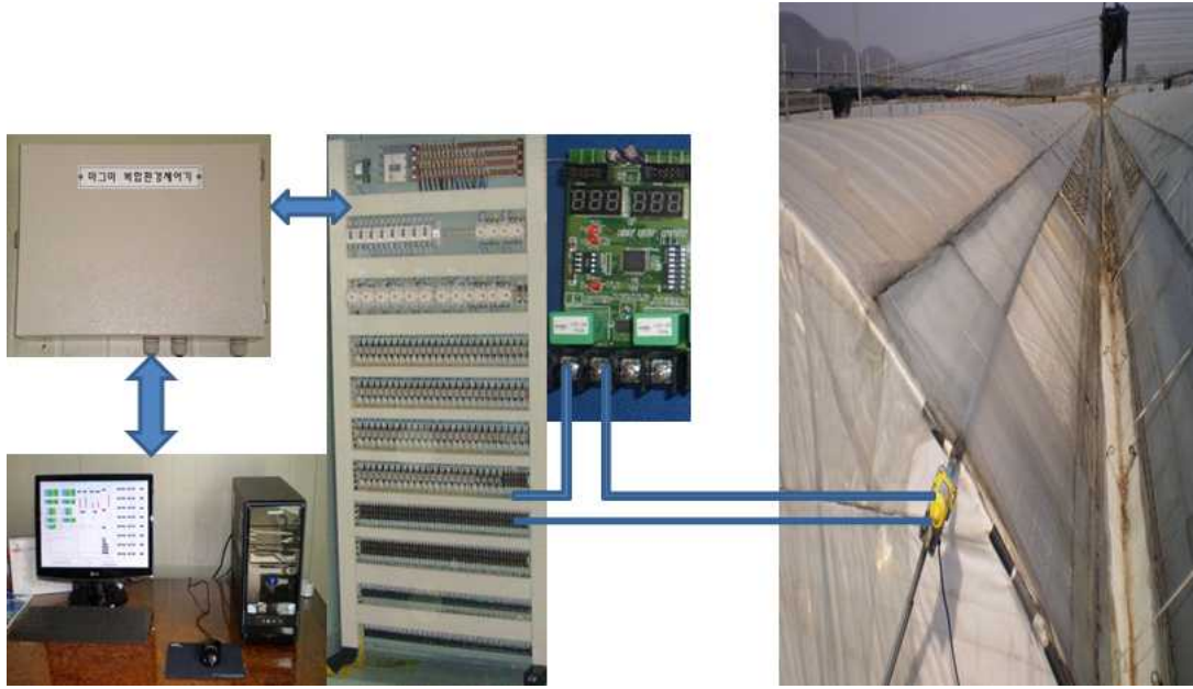
그림 8-6. 흡소자를 활용한 개도값 확인 장치 개념도
