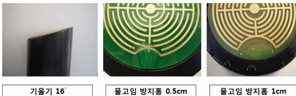
그림 7-5. 감지판 기울기 및 물고임 방지홈
