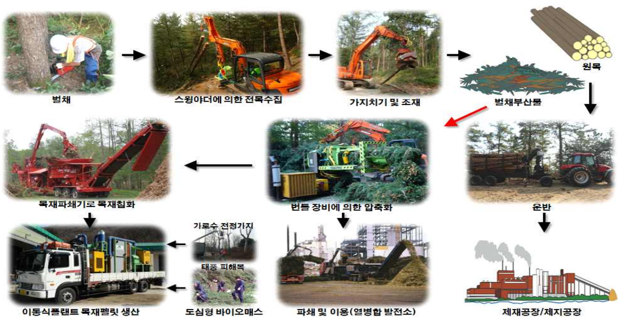
<그림 3-10> 국내 임지잔재의 수집 및 제품생산과정
