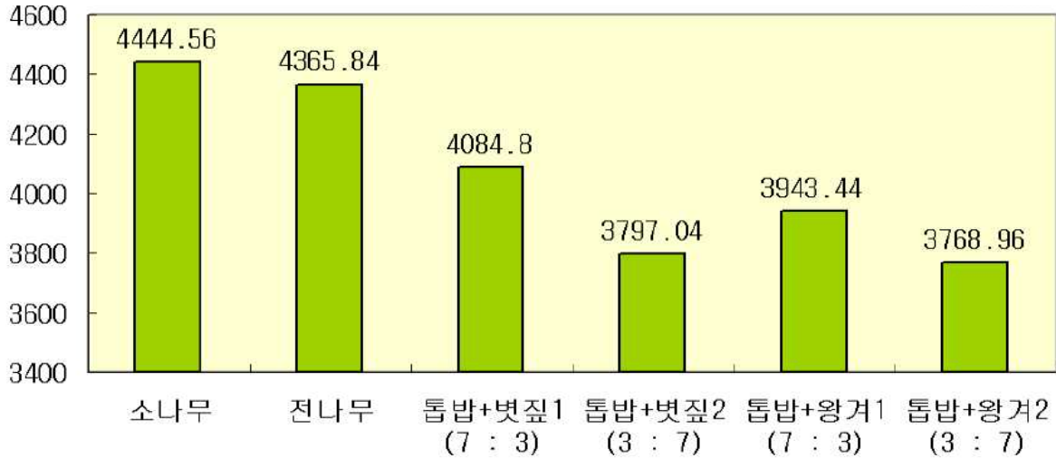
<그림 2-7> 임업부산물과 농업부산물 혼합펠릿 발열량
