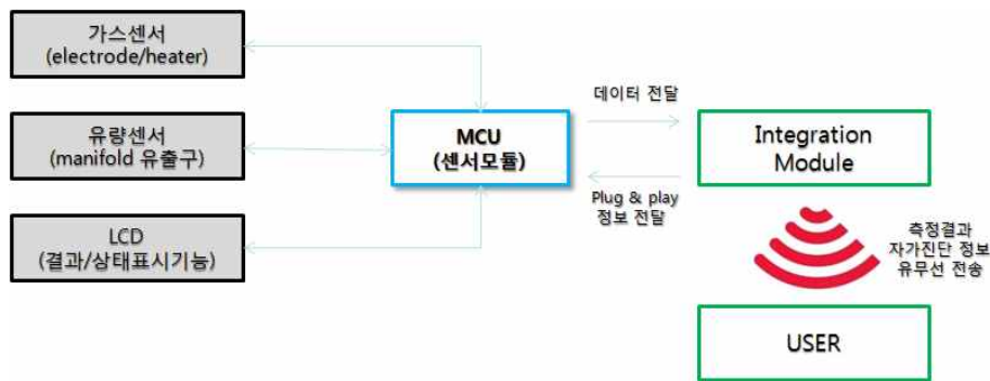
그림 3.15. Plug & Play 기능구현을 위한 PCB 설계/제작 블록도.
