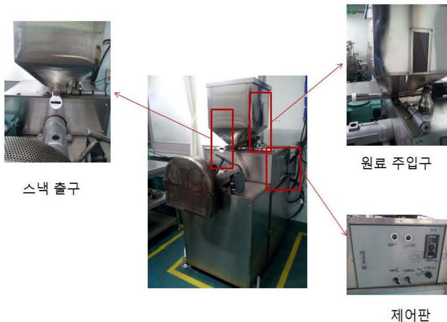
그림 3-4-1. 압출팽화 스낵의 제조 순서 (A)와 스낵의 제조에 사용된 압출 팽화기의 외관 (B).
