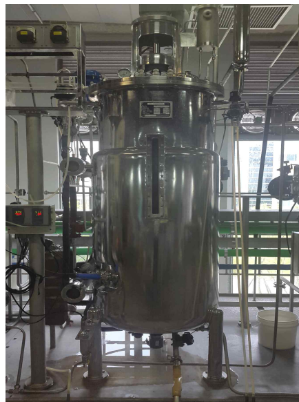
그림 13. 돼지감자 지상부 에탄올 발효에 사용된 500L 발효조
