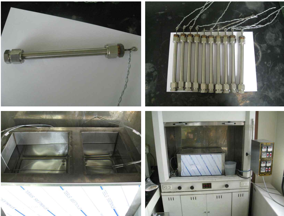
<그림 2-3. 회분식 전처리 반응 시스템>
