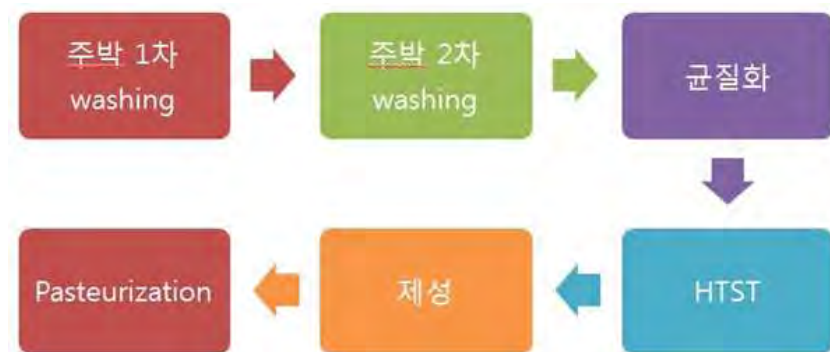
그림 3-3-54. 막걸리 주박을 활용한 항비만 음료 시제품 개발 공정 모식도
