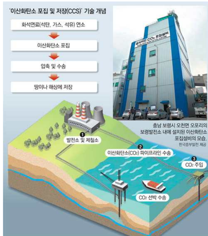
그림 5. CO 2 포집 및 저장 기술의 개념
