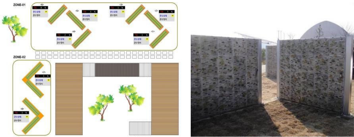
그림 32. 식생판 및 온습도 센서 배치도
