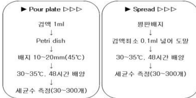
▲ 그림 3.111 세균수 시험 (결과 표기 : 측정세균수 X 검체 희석배율).
