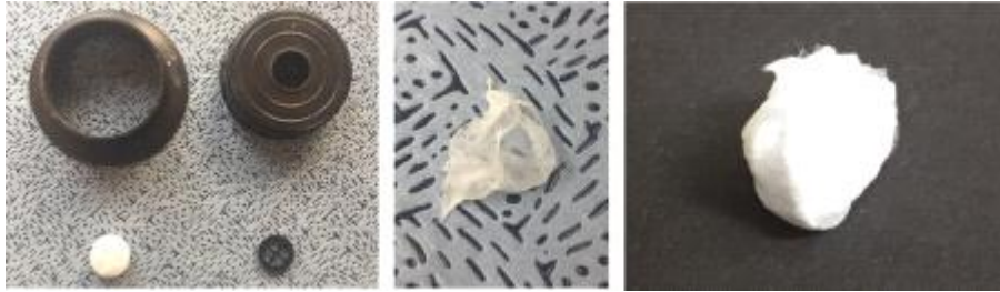
▲ 그림 3.34 비닐봉지 캡의 구성 및 Pullulan 나노섬유 솜.
