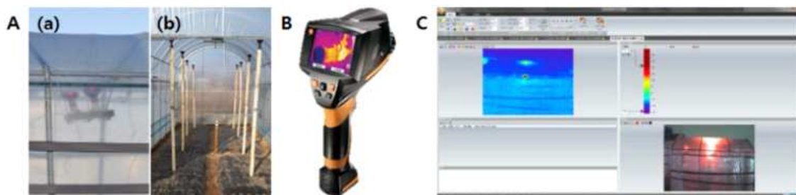
그림 97. 근적외선 램프 설치 상황 및 열화상 카메라 측정
