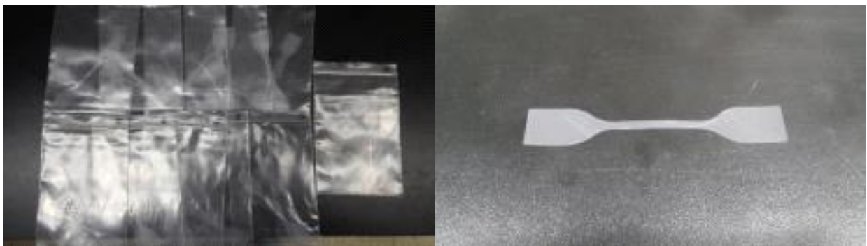
그림 72. 인장강도 실험을 위한 UTM 샘플
