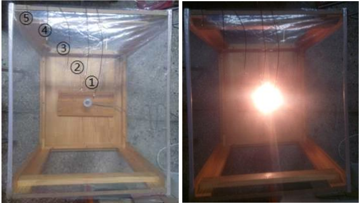
그림 62. 근적외선 흡수 기능성 온실피복재의 제설효과 적용에 따른 적외선 램프의 필요량 측정
