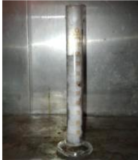
그림 53. 얼음가루의 밀도 측정
