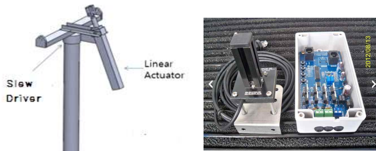
[그림 1-4] 태양광 2축 추적 장치와 컨트롤러
