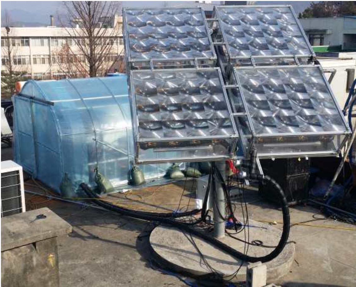
[그림 3-15] 다 모듈 복합시스템을 이용한 온실 난방을 실험설비
