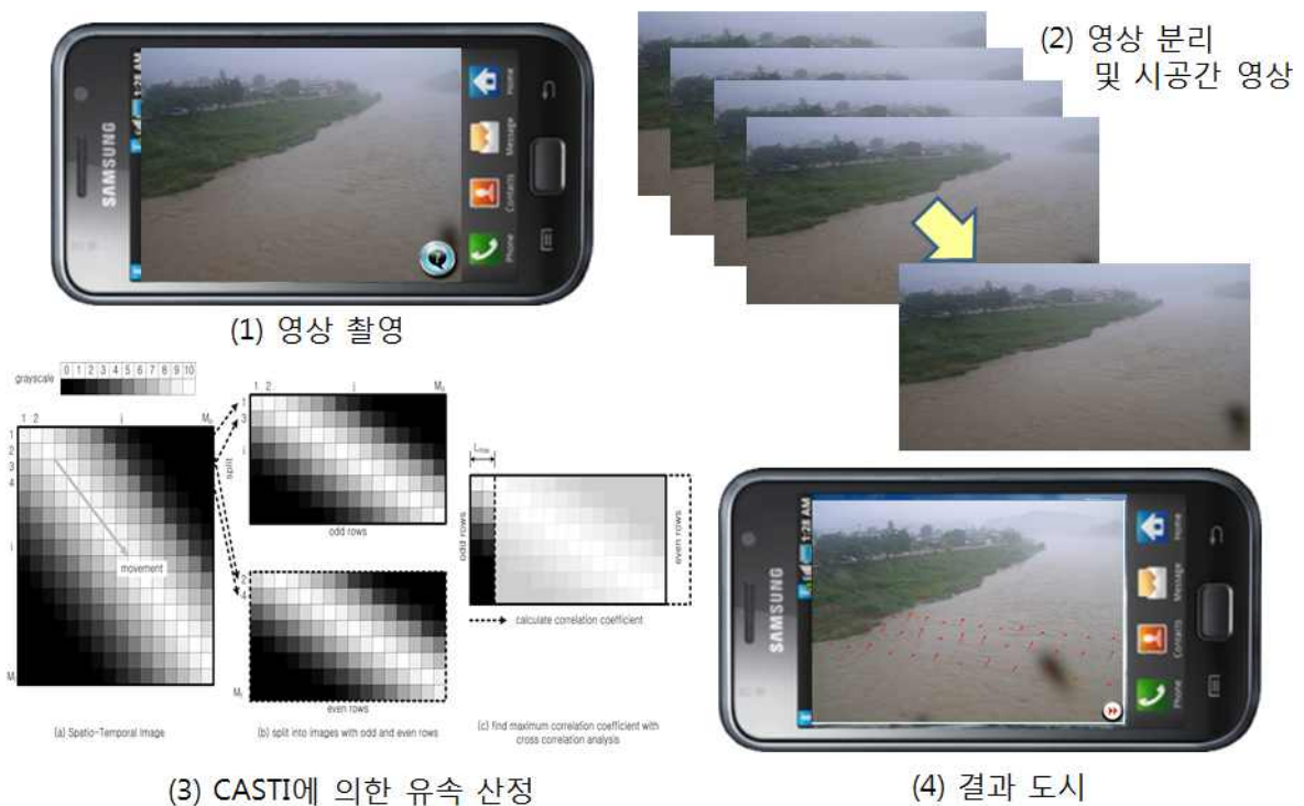
(그림 3-9-77) 스마트폰 영상유속계에 의한 유속 산정 개요도
