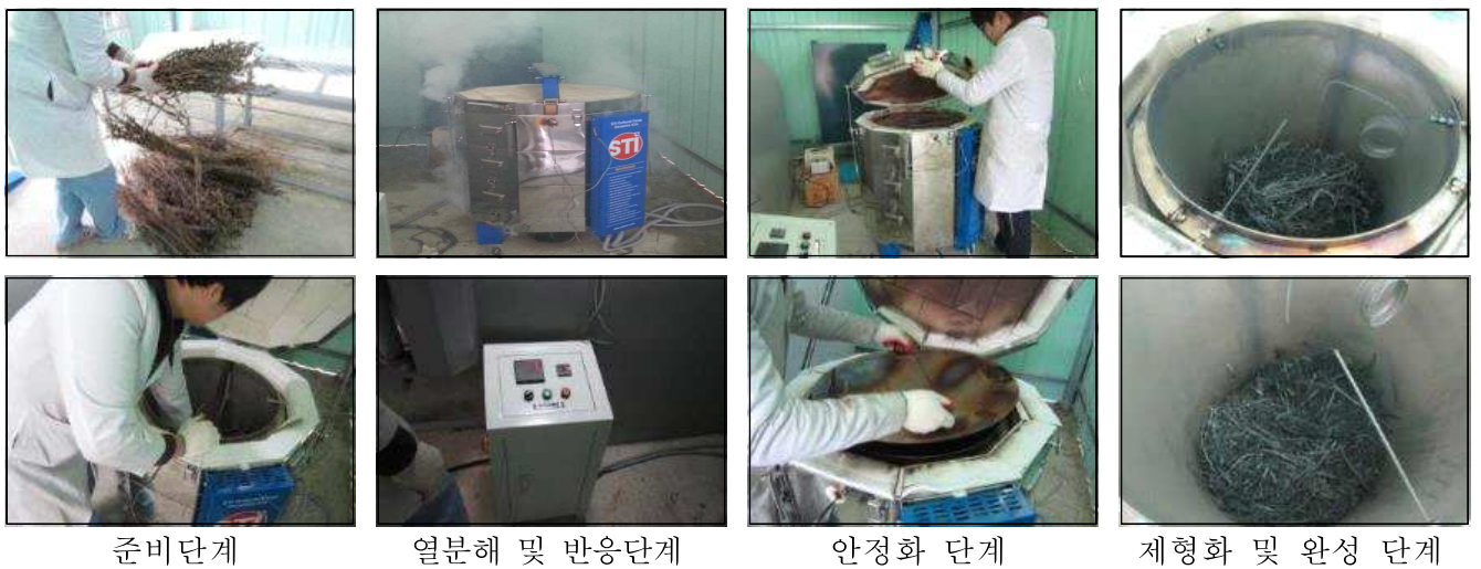
Fig. 3-289. 습식전기로 biochar 제조장치를 이용한 biochar 제조과정.
