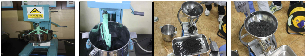
Fig. 3-431. 농림 부산물 biochar와 성형 보조제 결합 장치 및 제조장치.
