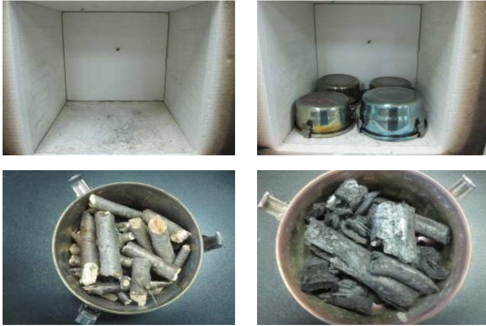
Fig. 3-42. 전기가열형 biochar 제조장치의 시운전.
