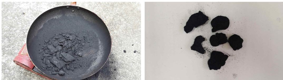
Fig. 3-426. 팬 과립장치를 이용하여 제작한 입상형 토양개량제.
