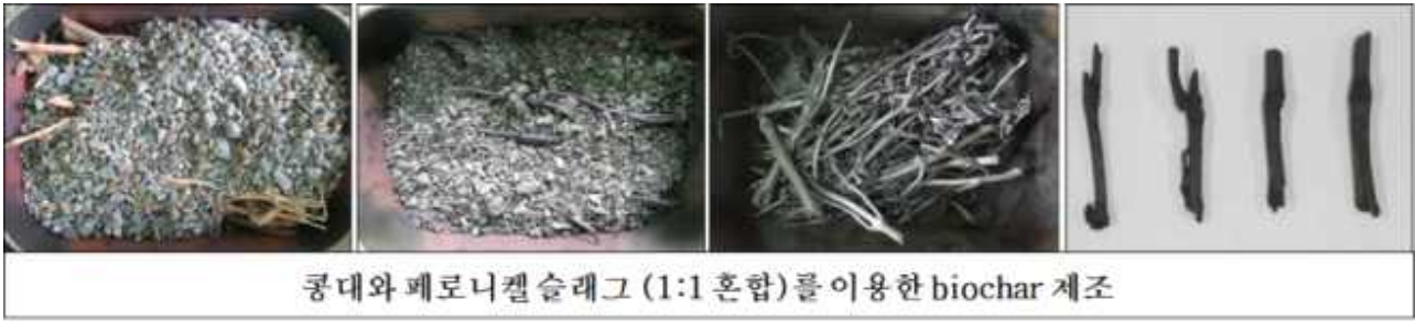
Fig. 3-332. 콩대와 페로니켈 슬래그 (1:1 혼합)를 이용한 biochar 제조 과정.
