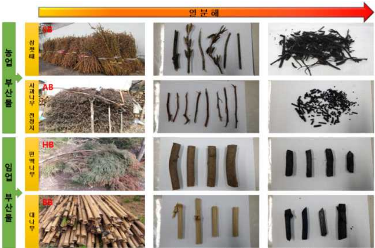
Fig. 3-425. Biochar 입상형 토양개량제 제조를 위한 참깨대, 사과나무 전정지, 편백나무 및 대나무의 열분해 과정.
