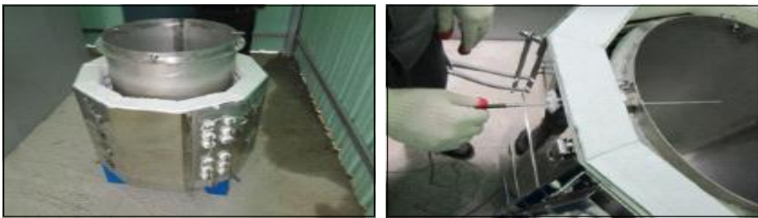
Fig. 3-421. Suss을 이용하여 제작한 내부 용기 삽입 및 질소가스 투입구 설치.
