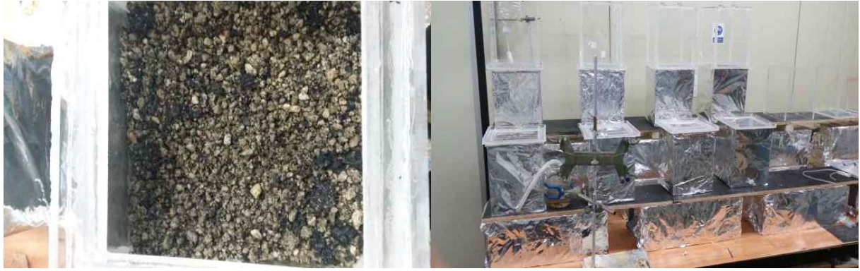
Fig. 3-26. 중금속 및 인 처리를 위한 소형 인공습지 전경
