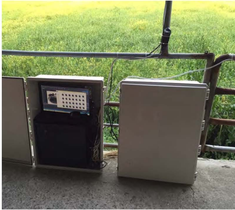
<그림 16> 센서 정보를 수집 및 분석하기 위해 설치한 컴퓨터
