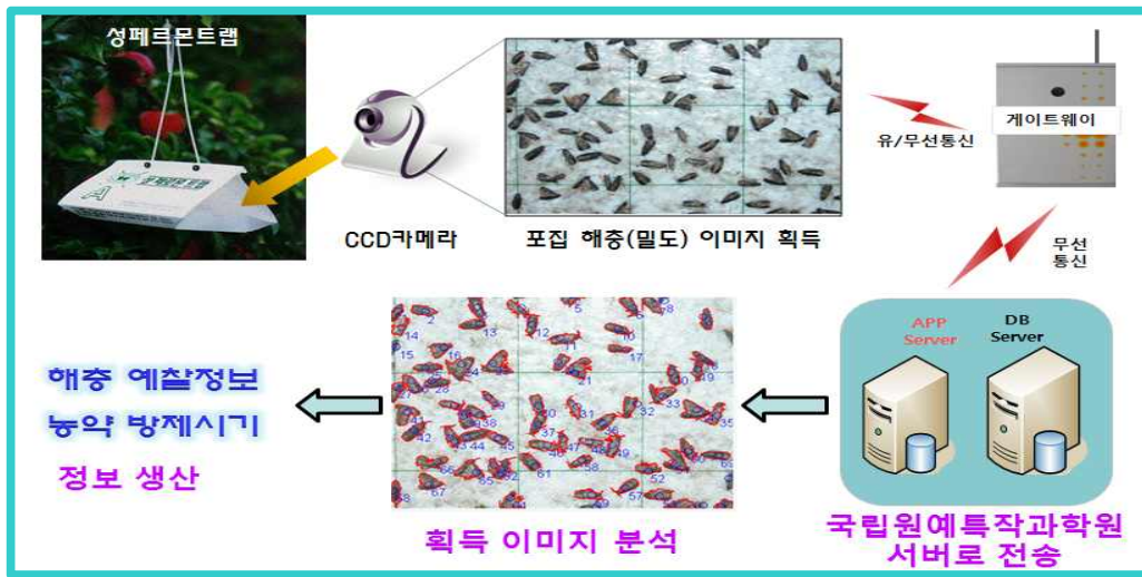
<그림 3-8> 무인 해충 발생 감시 장치의 정보 획득 구성도
