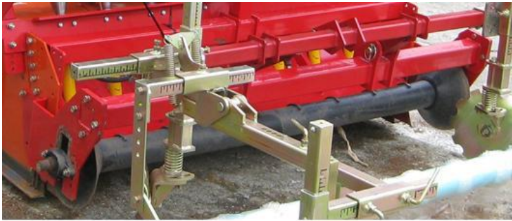
그림 30 마늘 마늘파종기에 장착된 진압롤러장치의 모습
