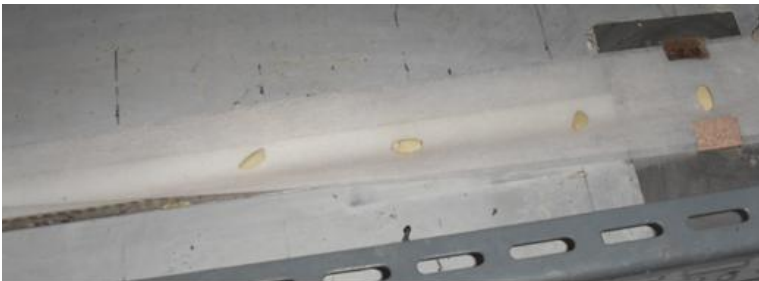
그림 8 종이 재질의 두루마리형태의 종이에 마늘 종자를 부착하는 모습
