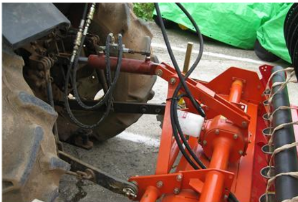
그림 7 상부링크 유압실린더의 트랙터 연결한 모습
