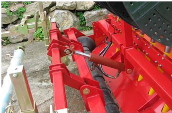
그림 34 비닐피복장치 높이 조절 장치 (유압실린더)
