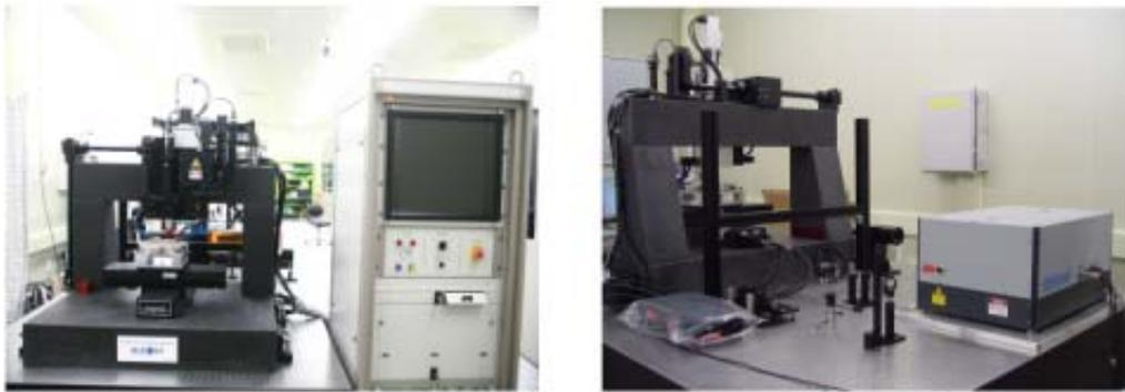
그림 8. 고반복률 펨토초 레이저 가공 시스템
