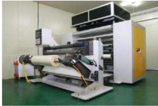
그림 18. UV 나노초 레이저 기반의 산업용 숨쉬는 필름 가공 시스템
