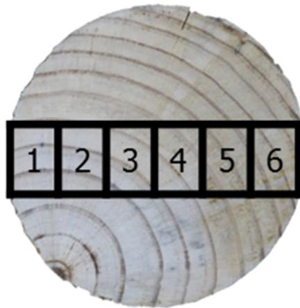
그림 3-3-14. 원주목 모습과 밀도 측정 시편 위치
