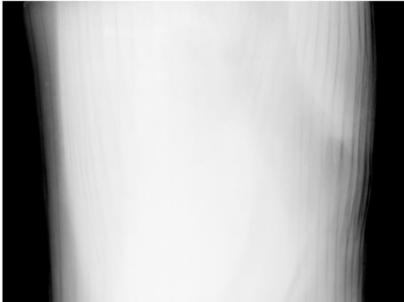
그림 3-3-2. 부후가 발생한 입목에 대한 방사선 사진 결과. 방사선 사진의 오른쪽에서 상대적으로 밀도가 낮은 부분이 관찰된다.
