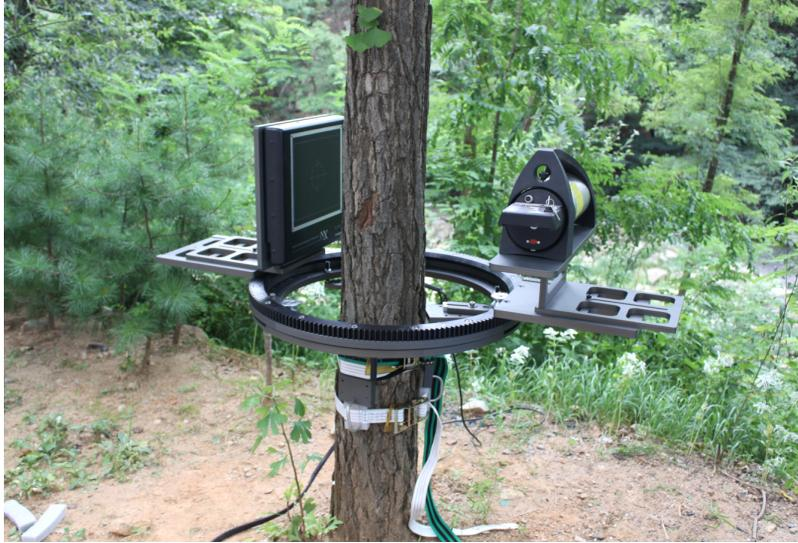
그림 3-4-24. CT 장치에 X선 선원 및 디지털 디텍터를 설치한 모습
