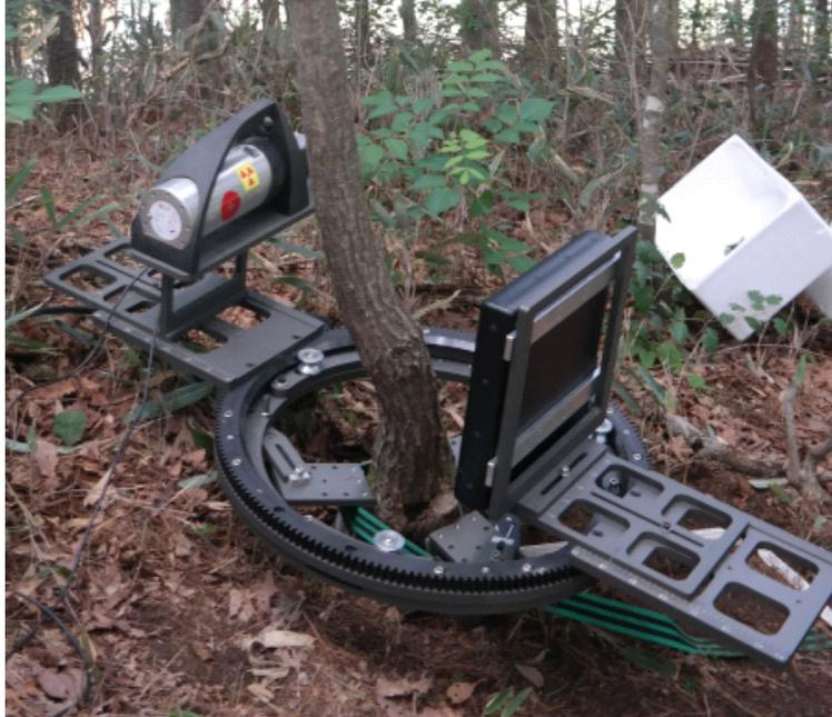
그림 3-5-2. X선 장비 설치 모습
