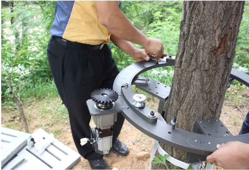
그림 3-4-20. 서보 모터 설치된 모습
