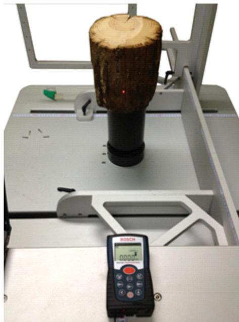
그림 3-3-18. 목재와 X선 선원의 중심 사이의 최단 거리 측정 모습
