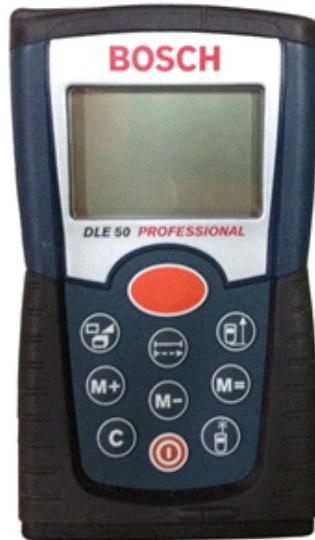
그림 3-3-16. 휴대용 거리 측정기 모습
