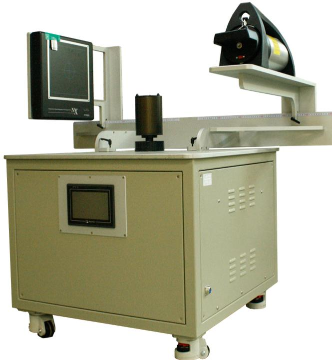
그림 3-2-6. X선 선원과 디지털 디텍터 사이의 거리 변경을 위한 실험실적 스케일의 CT 장비
