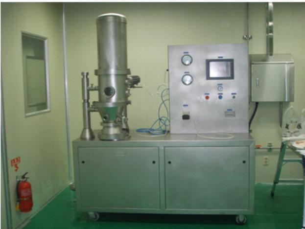
Fig. 42. 면역활성다당 원료의 과립화에 이용한 유동층과립기
