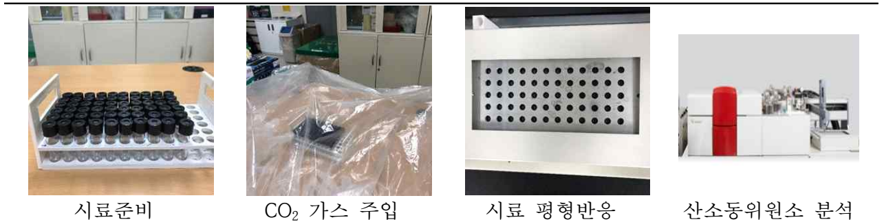
그림 2-2-10. 물 시료의 산소동위원소 분석 과정
