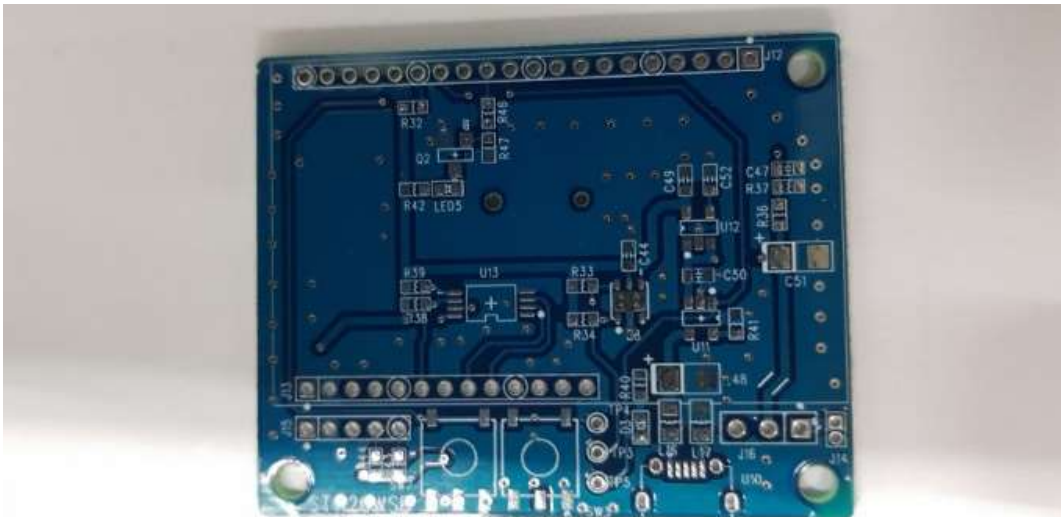
IoT 센서 단말 부문에 온도와 습도 센서를 삽입하고 기타 소자 부품을 설계한 PCB 사진임
