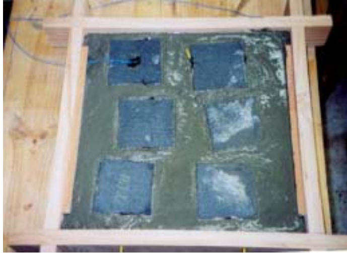
사진 12. 표면온도 측정을 위한 woodceramics 배열(콘크리트블럭형).
