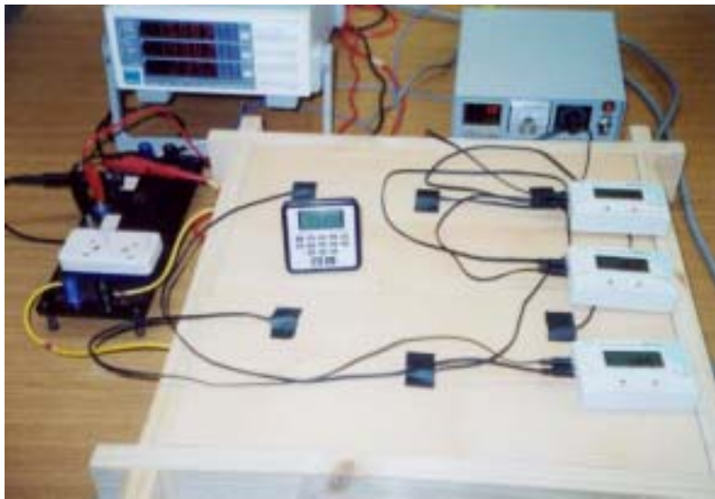
사진 13. 통전한 마루판의 표면온도 측정.
