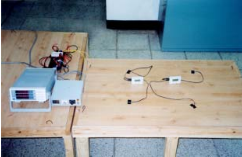
사진 16. 통전한 시작품 마루판의 표면온도 측정.
