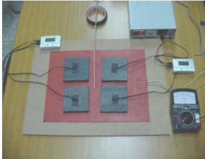
사진 9. 실리콘러버히터를 이용한 표면온도 측정.
