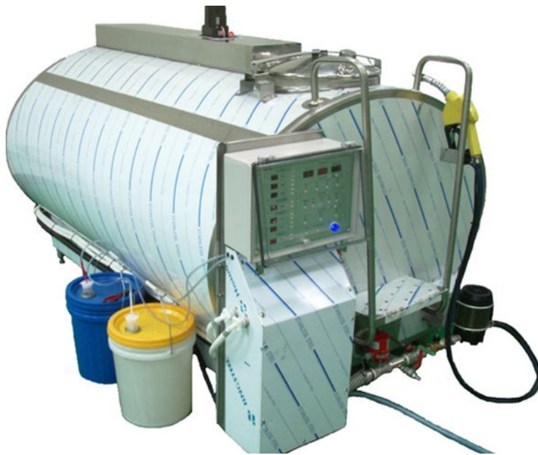
그림 5-5 티앤비테크놀로지의 대용량 미생물배양기 Bio-Water
