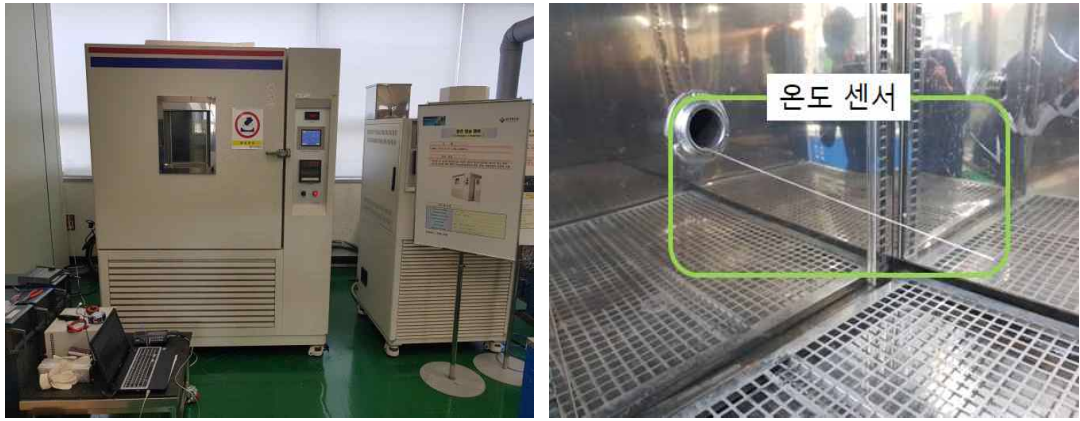
<환경 챔버 실험 장비(V-600C, VIVUS CO. LTD) 및 온도 센서 설치>
