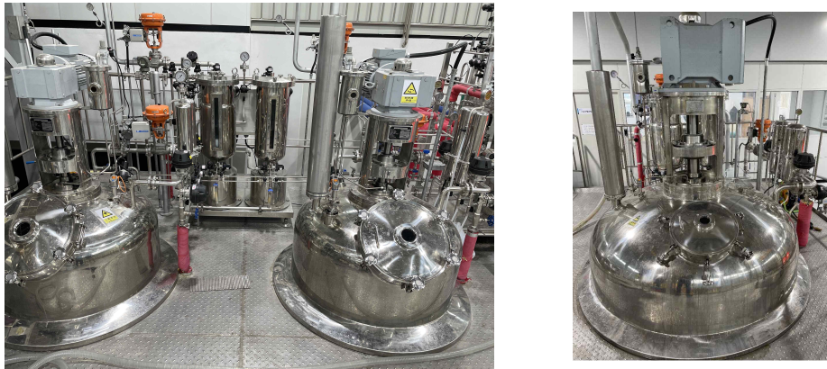
<그림 10. 1.5톤(좌), 10톤(우) 대용량 발효기를 이용한 유용미생물 대량생산>
