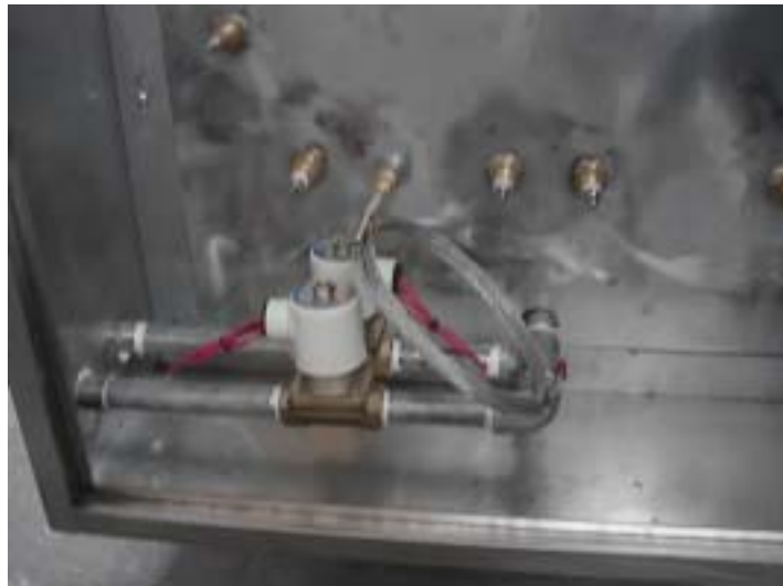
그림 3-9 급수 및 배수를 위한 솔레노이드 밸브
