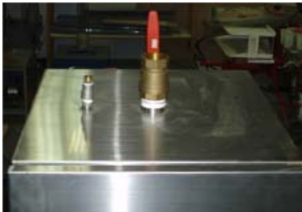
그림 2-8 증삼 및 건조챔버의 상단부에 설치된 배기구
