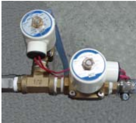
그림 2-9 급수 및 배수를 위한 솔레노이드 밸브
