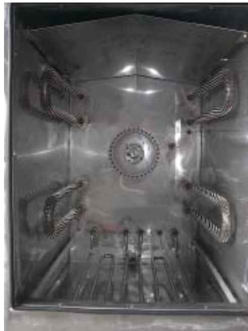
그림 3-3 증삼 및 건조챔버내부 전경
