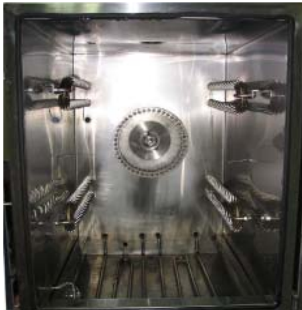
그림 2-3 증삼 및 건조챔버내부 전경
