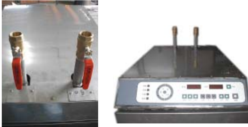
그림 3-8 증삼 및 건조챔버의 상단부에 설치된 배기구
