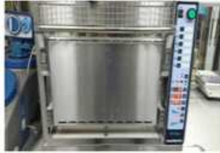
그림 139. 정치식 과열수증기기(QF5200C, Naomoto Co., Japan).
