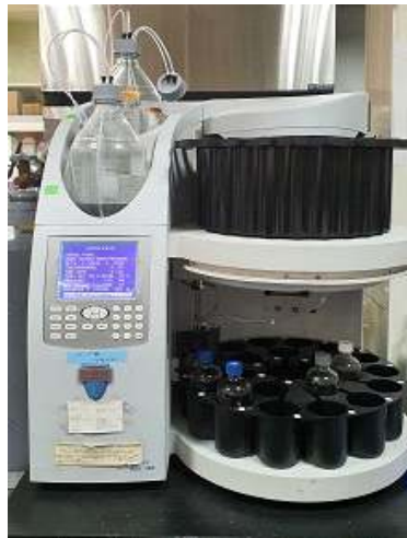
그림 144. 가압열수추출장비(ASE 350, Dionex, Sunnyvale, CA, USA).
