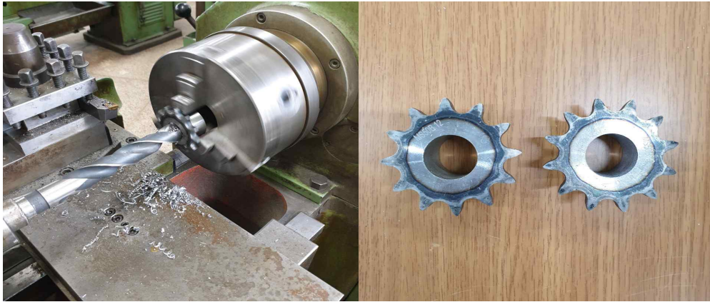
그림 77 스프로킷 홀 가공 및 멈춤나사 탭 가공
