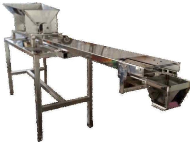
그림 62. 컨베이어 길이 고정식 조각과일 자동 계량 및 투입장치 시작기
