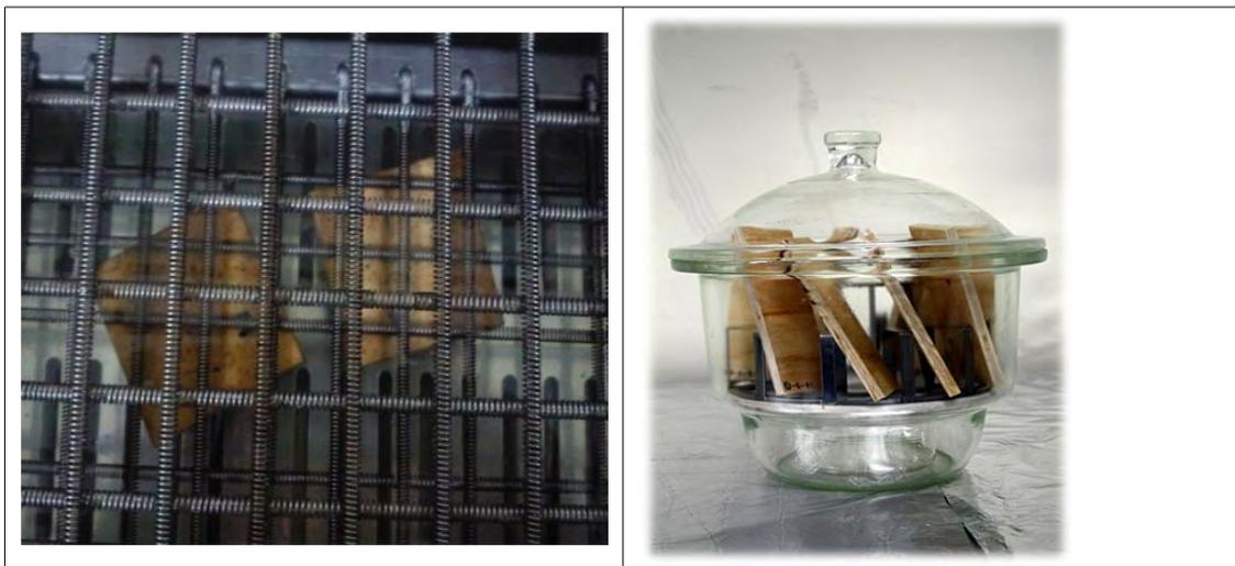
그림 3-2-39. 중밀도 섬유판의 두께팽창률 시험(왼쪽그림)과 포름알데히드 방산량 측정 시험(오른쪽 그림)
