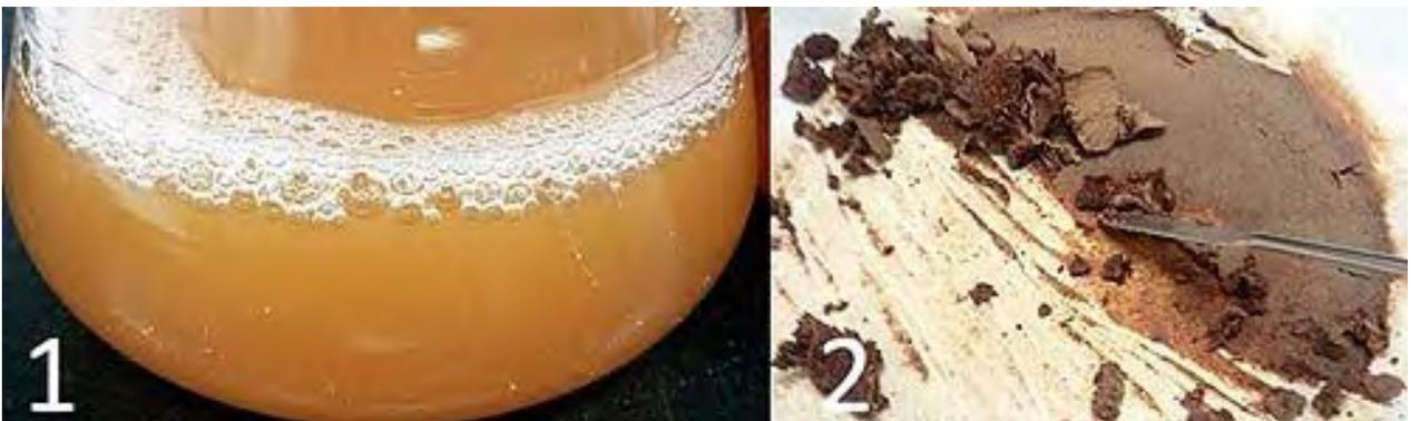
그림 3-1-24. 효소 가수분해 후 액상 (1) 및 여과 후 잔사 모습 (2)
