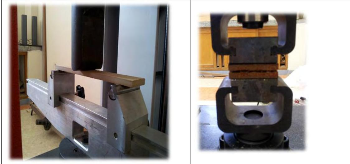
그림 3-2-38. 중밀도 섬유판의 휨 시험(왼쪽그림)과 박리강도 시험(오른쪽 그림)
