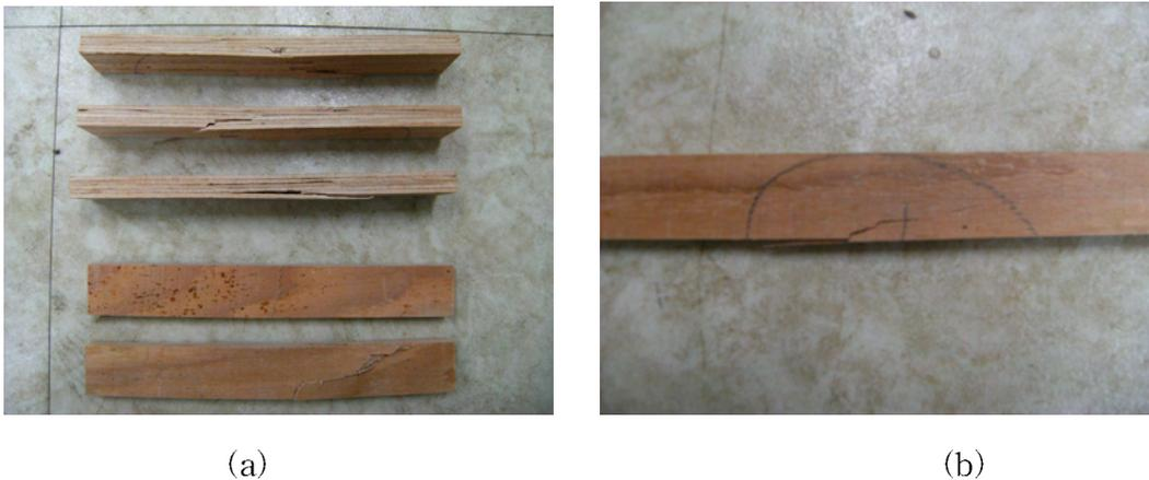
그림 3-2-23. 유채박 접착제로 제조한 단판적층재의 파괴양상(a; 평면휨시험 b; 측면휨시험)
