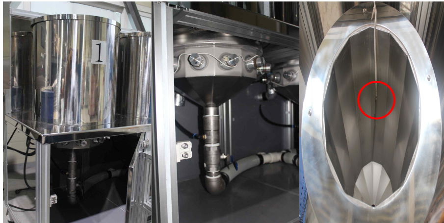
그림 58. 처리구 상세(초음파 처리기&내부+온도 센서)
