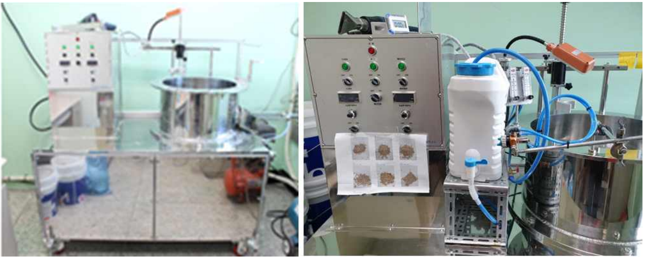
그림 79. 코팅장비의 기능 향상을 위한 수분자동장치 추가; 초기형태(좌), 수분자동장치 추가설치 모습(우)
