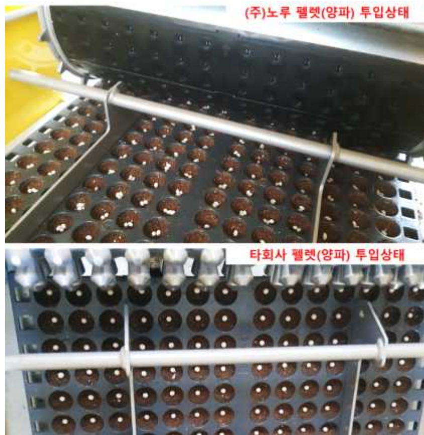
그림 60. (주)노루에서 개발한 DTK-5 펠릿코팅종자와 타 회사 펠릿종자의 기기과중상태 (노루의 경우 2-3립 이상씩 종자가 들어가 있는 것을 확인할 수 있음)
