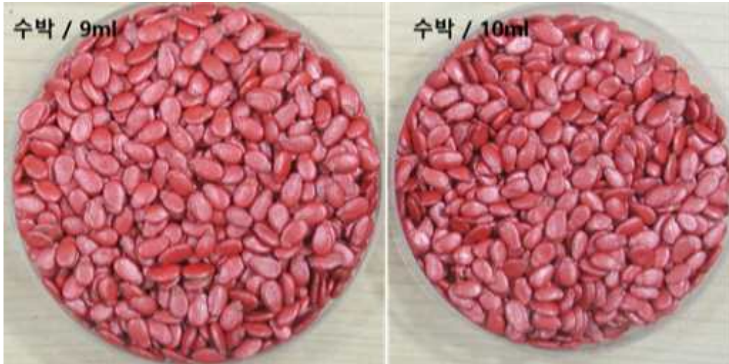
그림 40. (주)노루 TS-2 필름코팅 (발림성은 좋으나 약품냄새 심하고 용해도가 낮아 껍질이 벗겨짐이 심함.)
