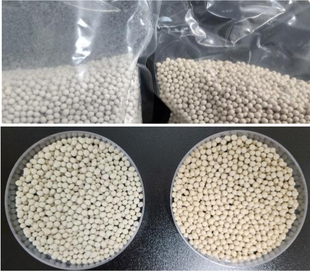
그림 64. (주)노루에서 개발한 DTK-8 펠렛과 타회사제품 펠렛 상태비교 (분진의 발생차이가 쉽게 식별이 되며 타원형의 펠렛이 다소 많다.)
