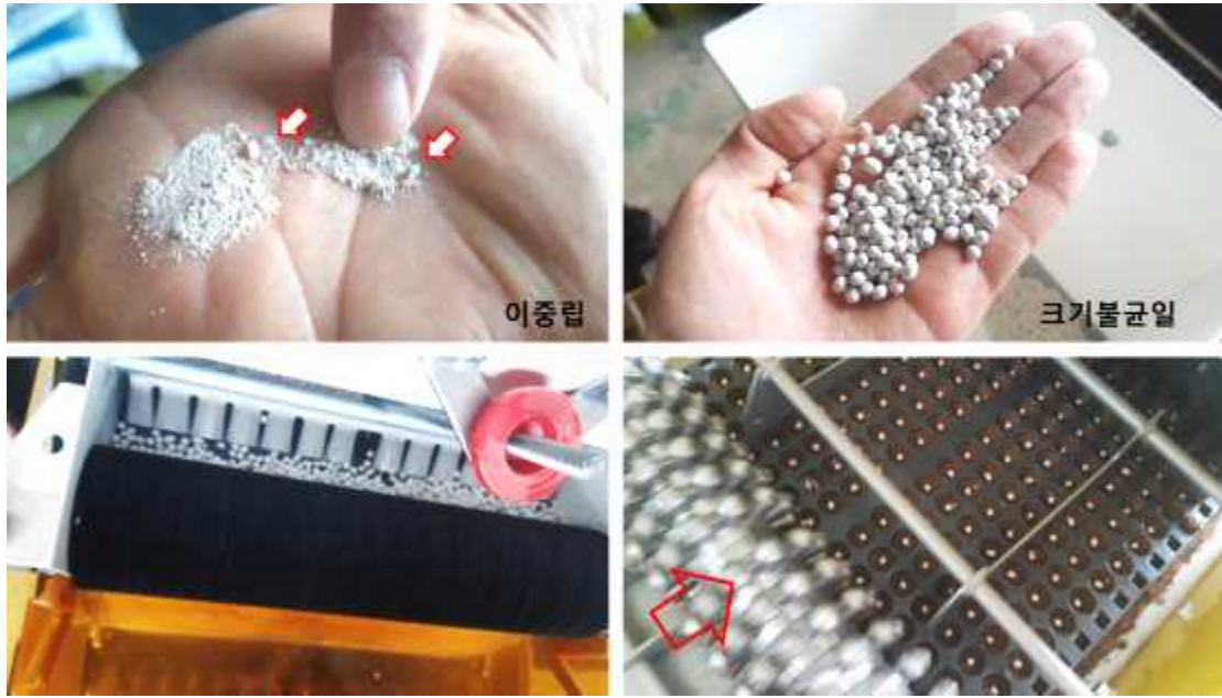
그림 61. (주)노루에서 개발한 DTK-5 펠렛과 타회사 펠렛제품 상태비교 (트레이에 종자가 위치한 뒤 화살표방향으로 상토가 깔리며 기계가 누르고 지나감.)
