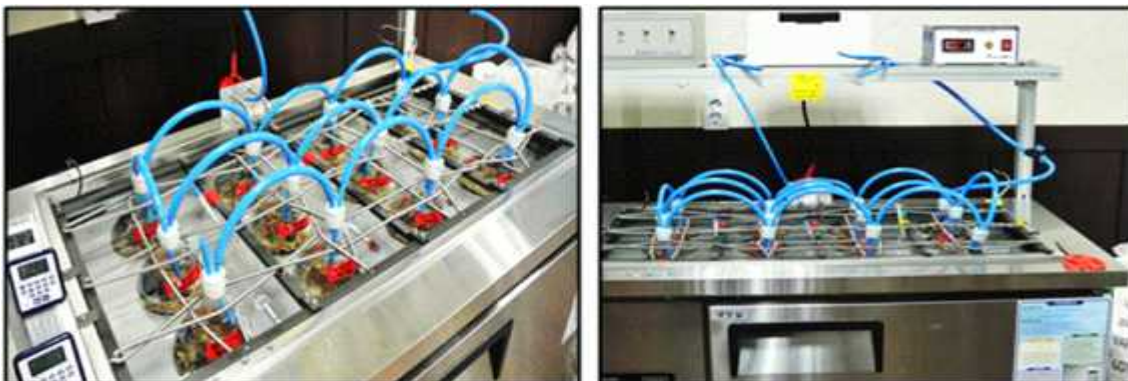
그림 2. 1차년도(2016년) 예비실험에 적용되고 있는 Lab scale의 프라이밍기기 (좌: 대목 프라이밍 처리 중인 모습, 우: Airation 주입시스템)
