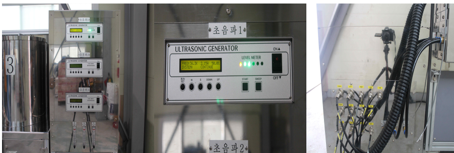
그림 57. 초음파+airation Control box 상세(조절부/ 세부 조절화면/후면 배선)
