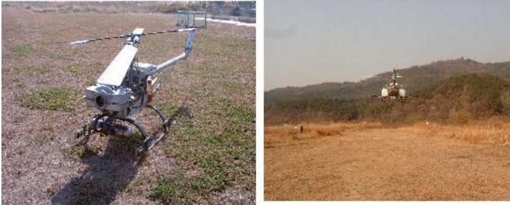
그림 4-1 헬리콥터 자세제어기를 개발하기 위한 균평기체 테스트베드
