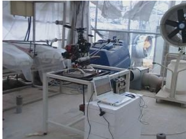
그림 3-32 모의시험장치를 이용한 비행자세 데이터 무선수집 실험
