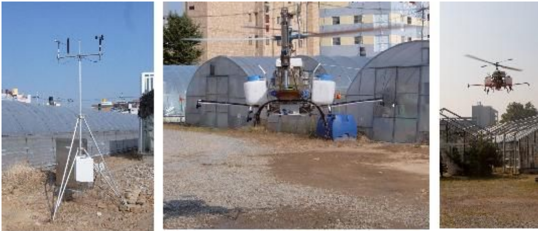
그림 3-40 균평기체의 살포분포를 측정하기 위한 액체살포장치의 장착과 기상 측정대 및 4m 살포 높이에서의 12m 길이의 면사실에 형광물질의 살포 장면
