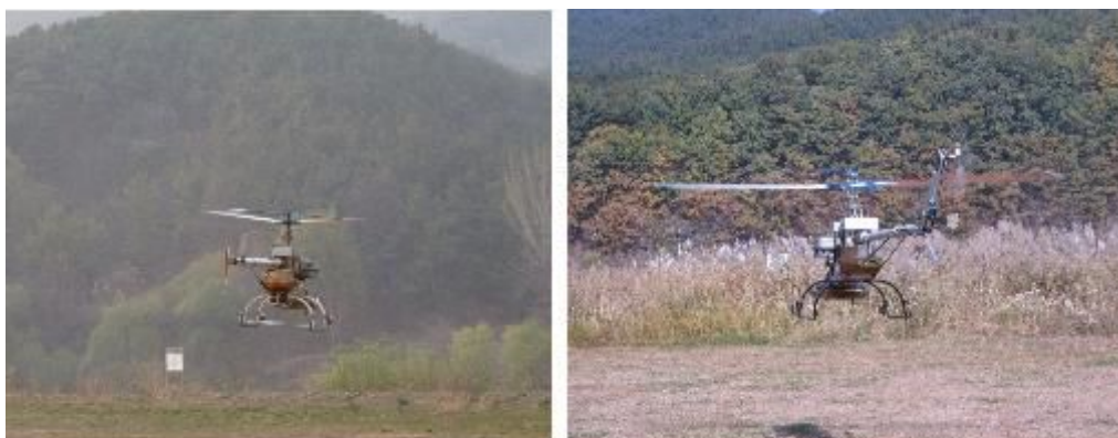
그림 3-49 관행농용헬기의 (a)기울임과 거양테일부를 장착한 기체의 (b)균평비행
