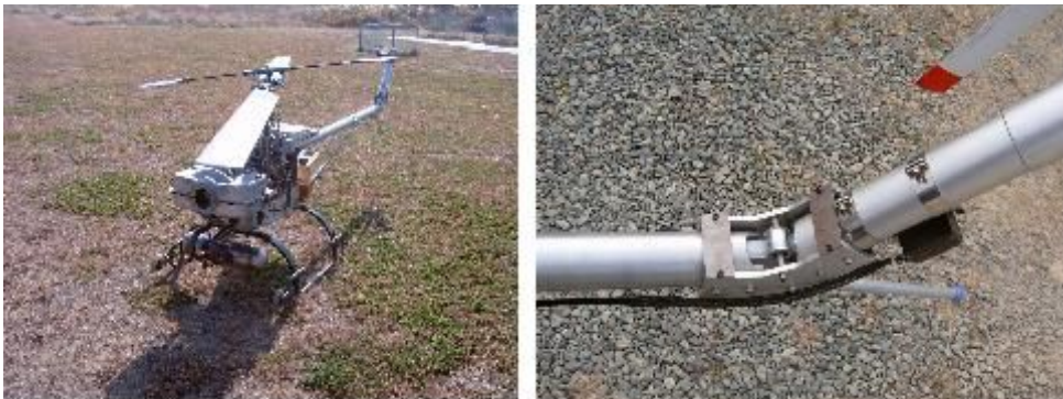
그림 3-38 균평기체를 위하여 설계된 거양식 테일로터와 기체의 구현
