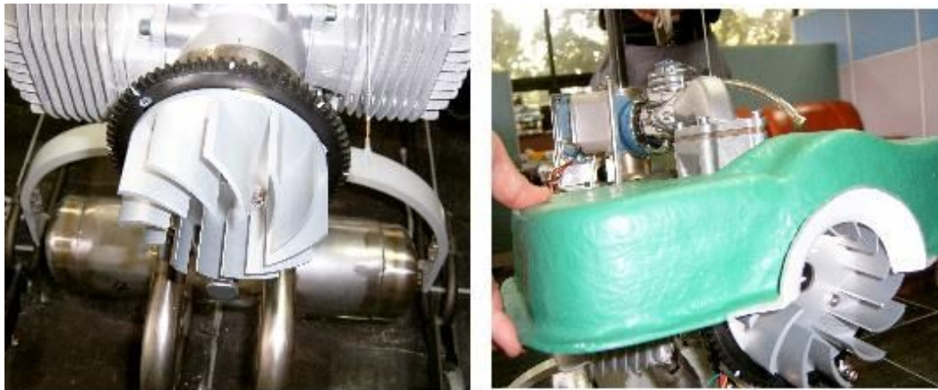
그림 3-21 설계 제작된 냉각팬의 형태와 덕트의 모양
