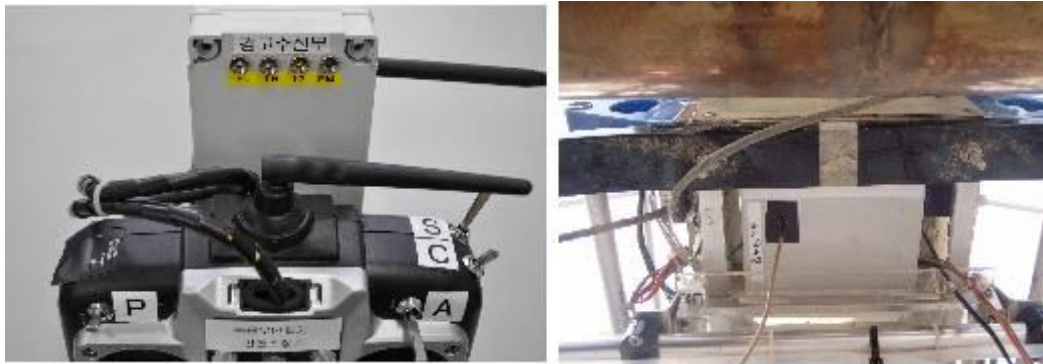
그림 4-93 양방향 간편조종기의 채널 지정과 경보 송신부의 기체 장착
