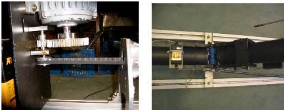
그림 3-10 거양테일부의 절곡형 벨트구동 장치 설계
