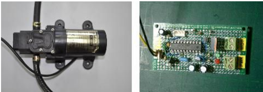
그림 3-24 무인 헬리콥터 방제장치에 사용된 무선제어시스템과 다이어프램펌프
