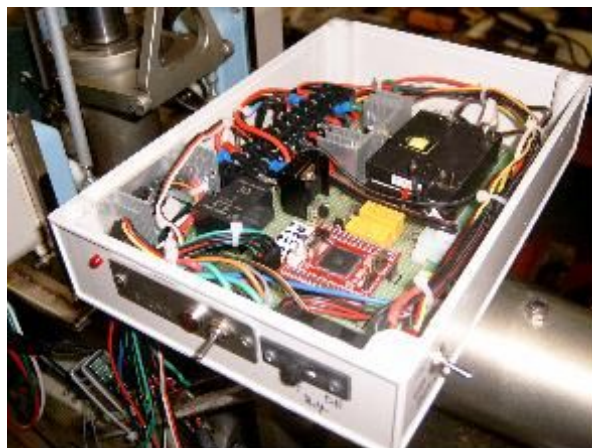
그림 3-29 원격시동, 엔진정지 및 살포제어 기능을 통합한 메인 스위치 모듈
