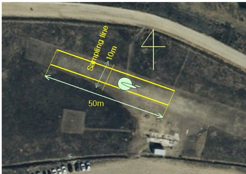
그림 3-42 균평기체의 살포비행 및 살포균일도 측정을 위한 배치도
