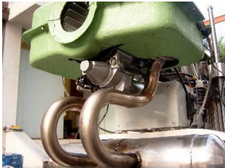
그림 3-20. 엔진의 흡배기 및 냉각장치의 설치와 헤드온도 측정
