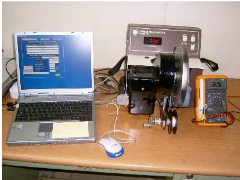
그림 3-41 실험에서 면사실에 수집된 형광 물질 Rhodamine B(WT)의 수준을 측정하기 위한 WRK String Analysis 시스템
