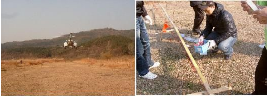
그림 3-43 구간 살포비행의 모습과 비행 살포분포를 측정하기 위한 감수지의 배치
