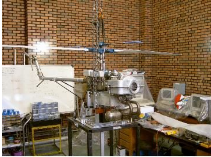
그림 3-34 농용 무인헬기의 모의시험장치에 장착된 개발 헬리콥터
