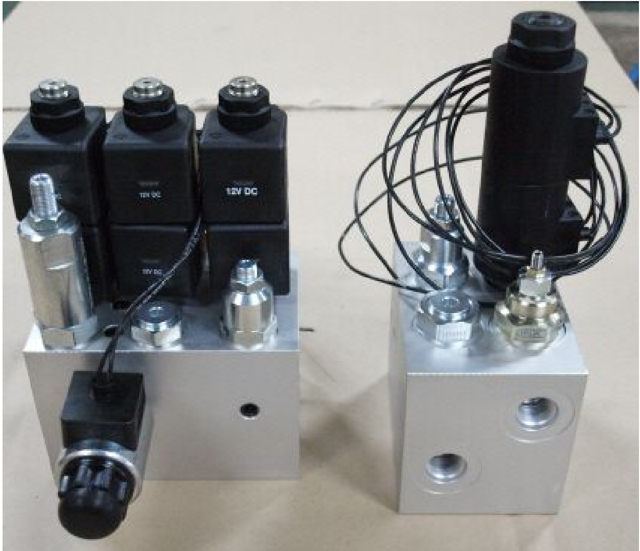
그림 19. 작업기 동작 및 전후 회전을 위한 유압제어회로 조립체 시작기
