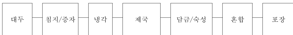
그림 3. Manufacturing process of Doenjang products
