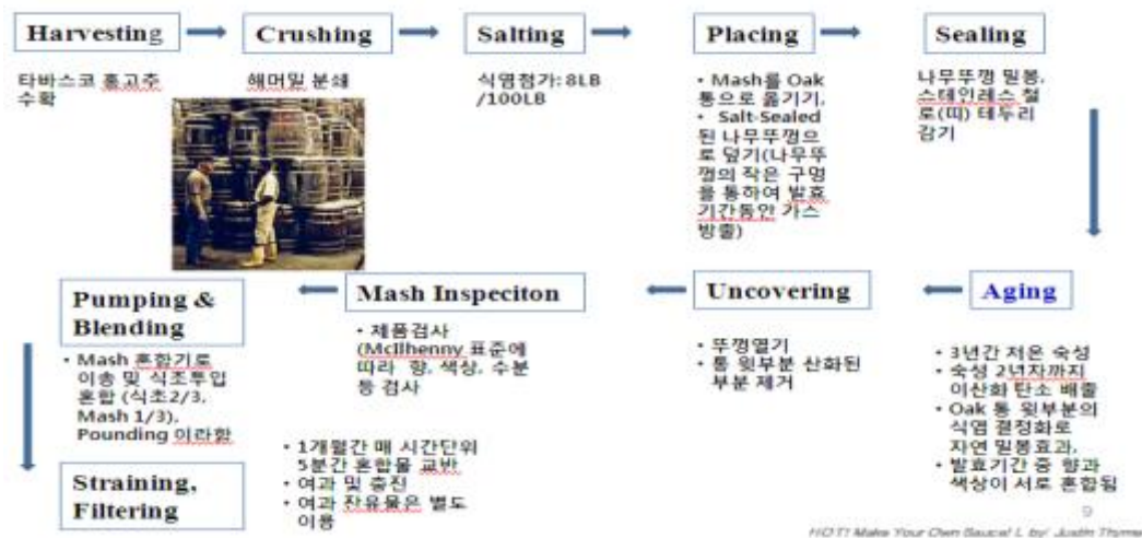
그림 01. Tabasco Hot Sauc의 제조공정 예시
