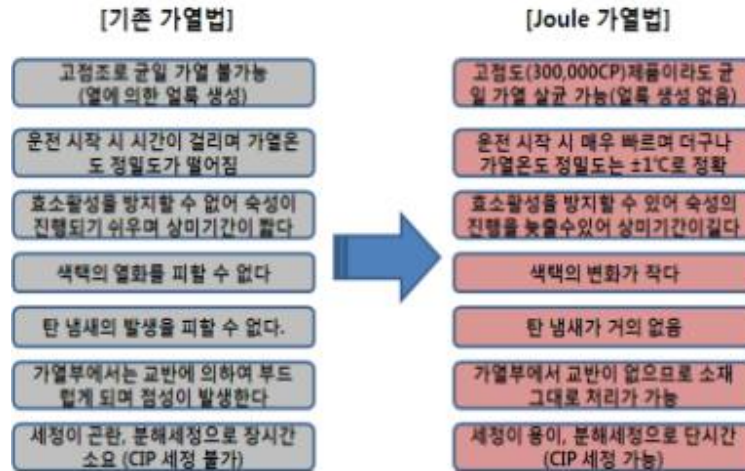
그림 15. Comparison of Joule heating and general heating
